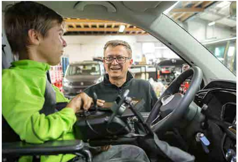
seines Fahrzeuges wie Blinker, Scheibenwischer oder Sonnenblende kann er über das PARAVAN-Touchsystem, die Sprachsteuerung oder über seine App auf dem Smartphone bedienen. Ein zusätzlich installiertes Kamerasystem mit Umfelderkennung sorgt für einen sicheren Rundumblick.
