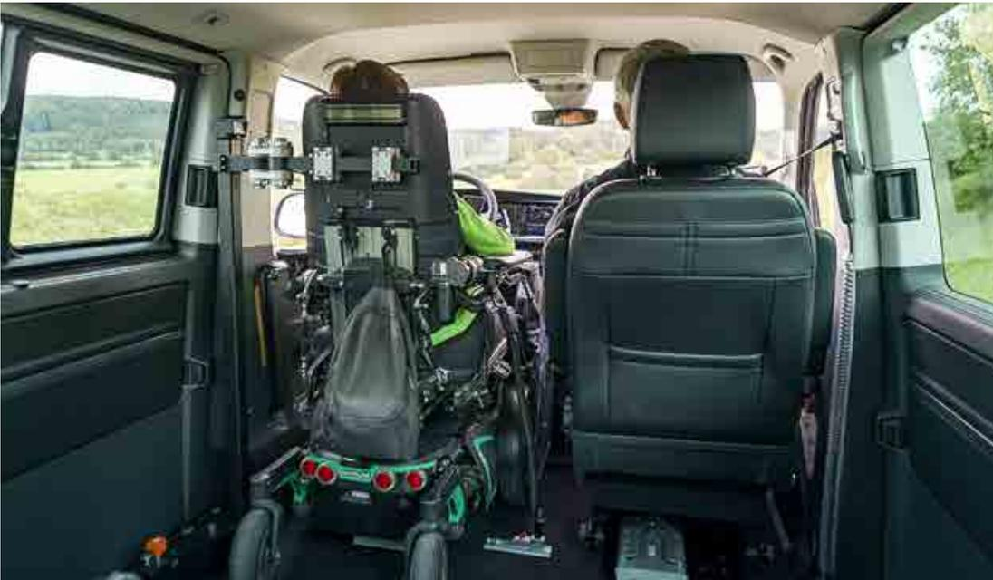
← **Letzte Checkfahrt** mit Fahrlehrer Horst Hilsenbeck. Jetzt werden alle Einstellungen noch einmal geprüft: Ist ein ermüdungsfreies Fahren gewährleistet, passen die Verankerungen und die Rückstütze für den zusätzlichen Halt im Rollstuhl?
